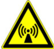
Dieses Symbol warnt vor **nicht-ionisierende elektromagnetische Strahlung**. (Bildzeichen 5140 der IEC 60417-1)
